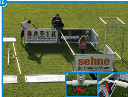
Seitenteil „Barth“ einsetzen und in Linie ausrichten.
