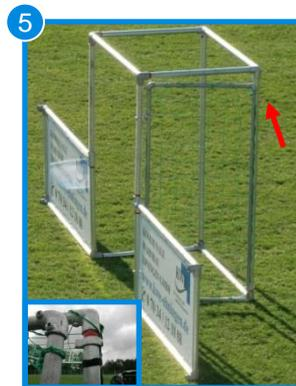
Tür des rechten Tores einsetzen. Evt. Türanschlag an dem hinteren Torpfosten ausrichten.
