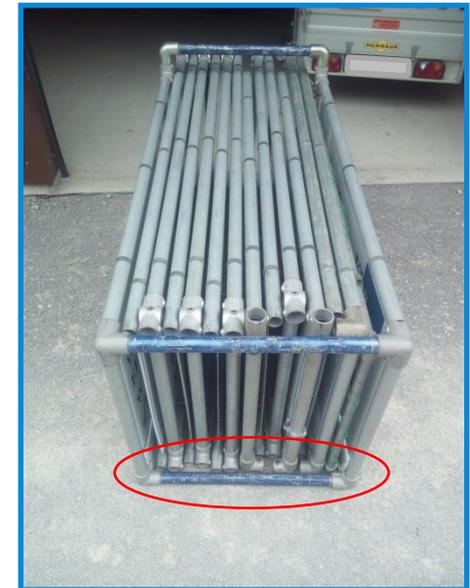
*Besonders bei den Eckverbindern ist eine optimierte Zusammenstellung notwendig damit kein Platz verschwendet wird.*
