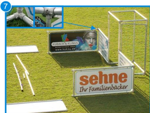
7 Seitenteil „Kubach“ einsetzen und im 90° Winkel zum Stirnteil „KWE“ ausrichten. Die Madenschrauben in der Ecke anziehen (handfest).
