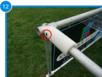
12 Die Handschutztülle auf einer Seite auf das Querrohr stecken (Inbusmade zeigt nach außen). Das schwarze Kunststoffrohr mit den Handschlaufen über das zusammengesteckte Querrohr schieben. Die zweite Handschutztülle auf das Querrohr schieben. Das Querrohr nun in die Seitenteile einfädeln und nach außen bündig abschließen lassen. Seitenteile ausrichten und Querrohr festschrauben (handfest).
